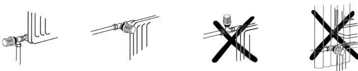
Obr. 3. Příklad správné a nesprávné instalace termostatických hlavic Thera-2
